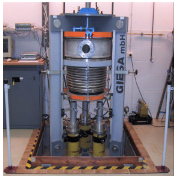
Großtriaxialschergerät in Versuchsstellung
