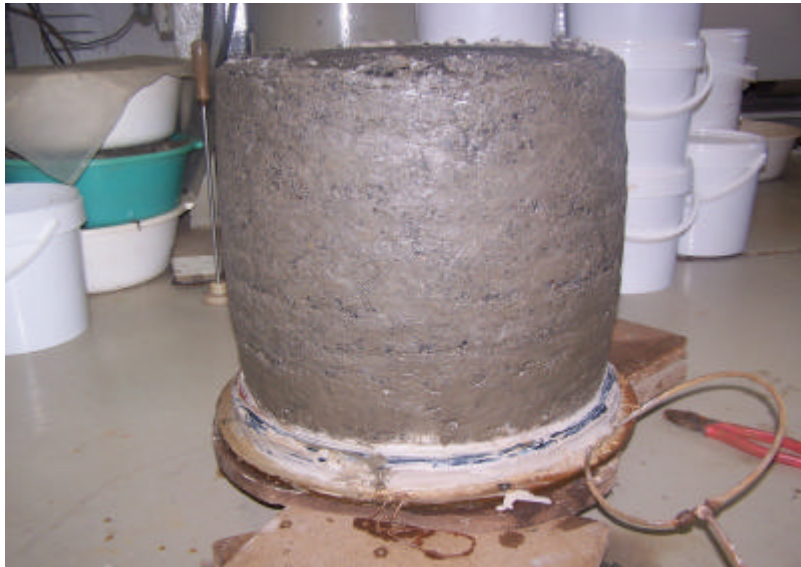
Großprobe nach dem Scherversuch
